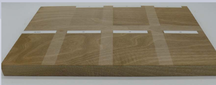
Abb. 1 Erste Anwendungsversuche der Wachsemulsionen zur Einpflege von Eichenholz-Oberflächen im direkten Vergleich zu herkömmlichen Carnaubawachs-haltigen Formulierungen. © hollu Systemhygiene GmbH (Abteilung Forschung & Entwicklung)
